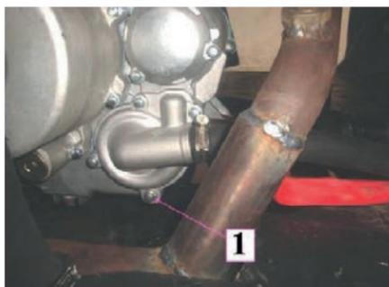
1. Сливная заглушка для охлаждающей жидкости
