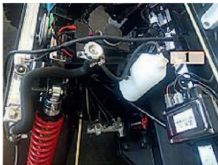
Когда транспортное средство находится на ровной поверхности, уровень жидкости в емкости для охлаждающей жидкости должен быть между отметками MIN и MAX.
