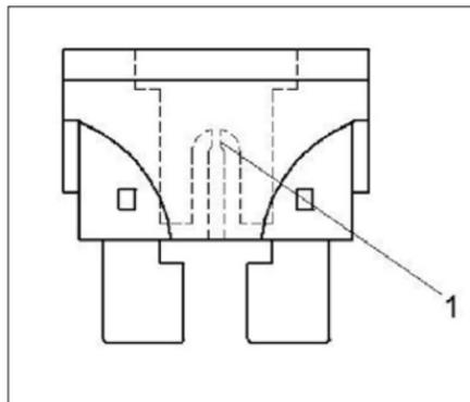
(1) Перегоревший предохранитель
