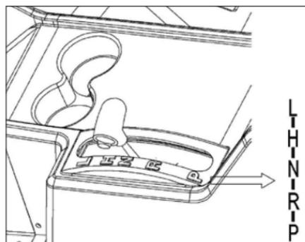
Перед эксплуатацией транспортного средства проверьте работу рычага переключения передач и убедитесь, что переключение передач от L до P и заднего хода выполняется плавно.
