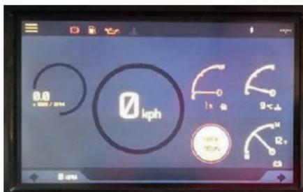
На дисплее с приборами показаны следующие параметры: скорость, обороты двигателя, дальний свет, поворотный сигнал, тормоз, давление масла, температура охлаждающей жидкости, уровень топлива.
