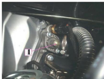
Пережмите шланг между радиатором и корпусом термостата большим зажимом или аналогичным устройством.
